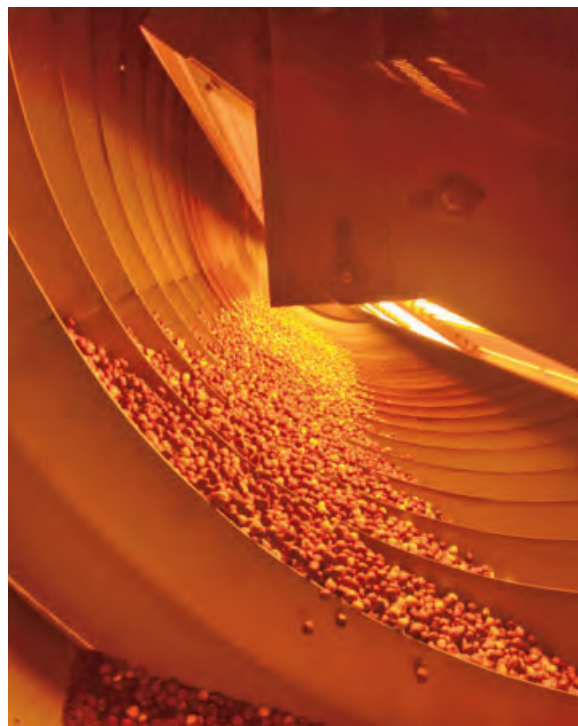
Die Haselnüsse für Rapunzels Nussmuse werden vor Ort schonend im Infrarotdrehrohr geröstet.
