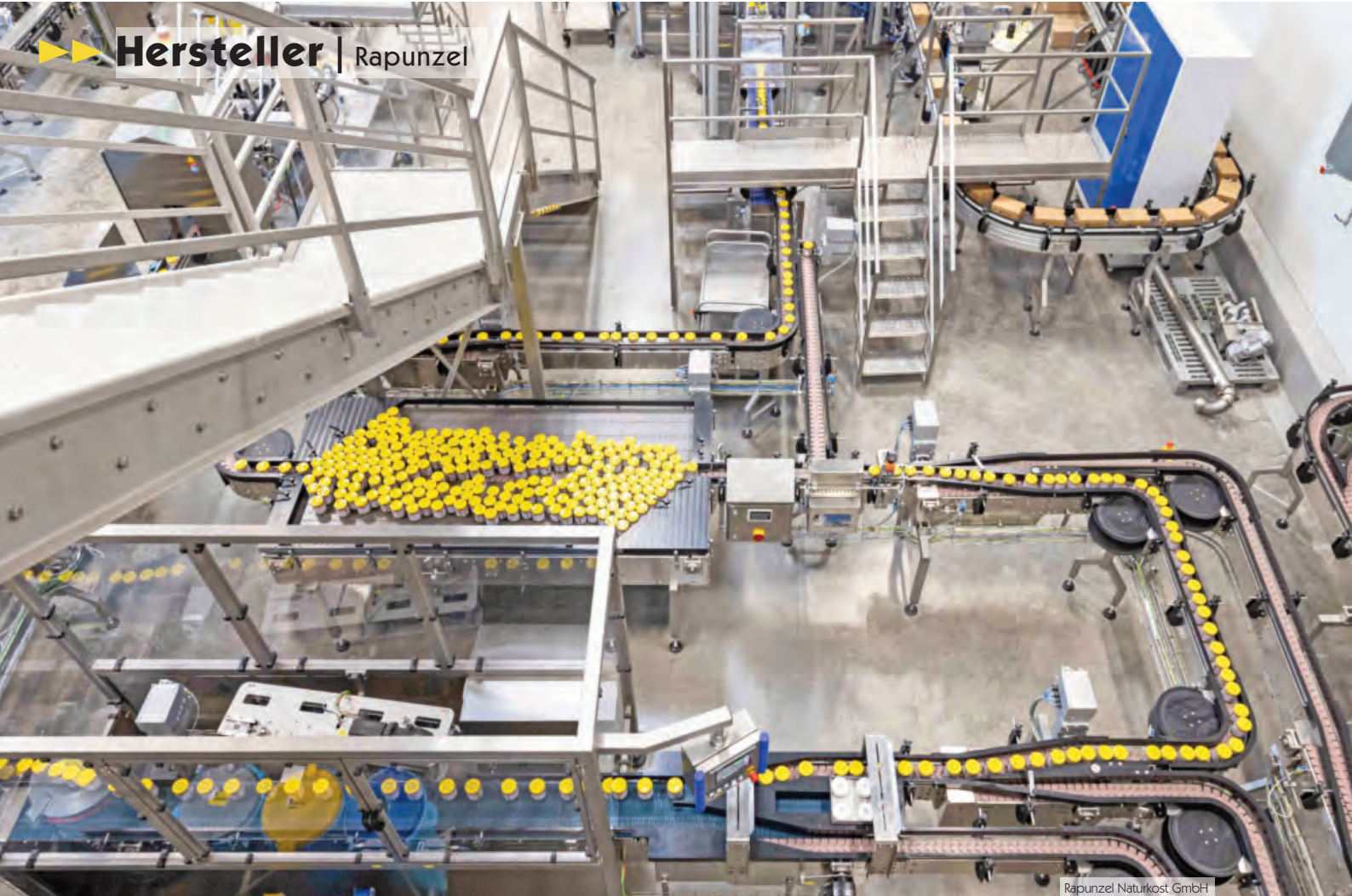
Samba-Haselnussmus in Fülle: Die neueste Abfüllanlage Rapunzels schafft 115 Gläser pro Minute.
