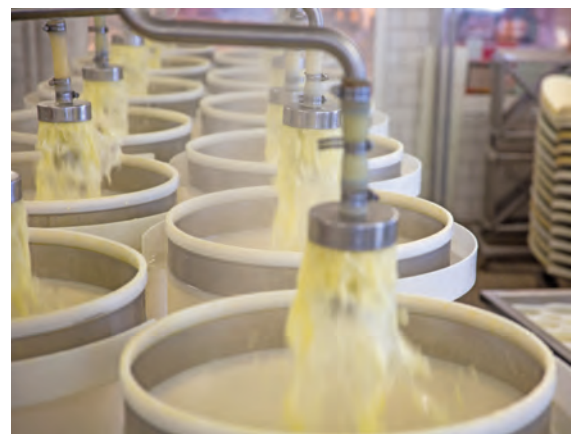
Eine wendbare Käsepresse mit zwölf Siebformen sorgt für die Trennung von Käsebruch und Molke (r.). Senner befreien fertige Käselaibe aus ihrer Form (l.).
