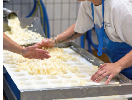
Von Hand verteilen Naturmælks Käsemeister die Bruchstücke in Platten mit 66 runden Laibformen.
